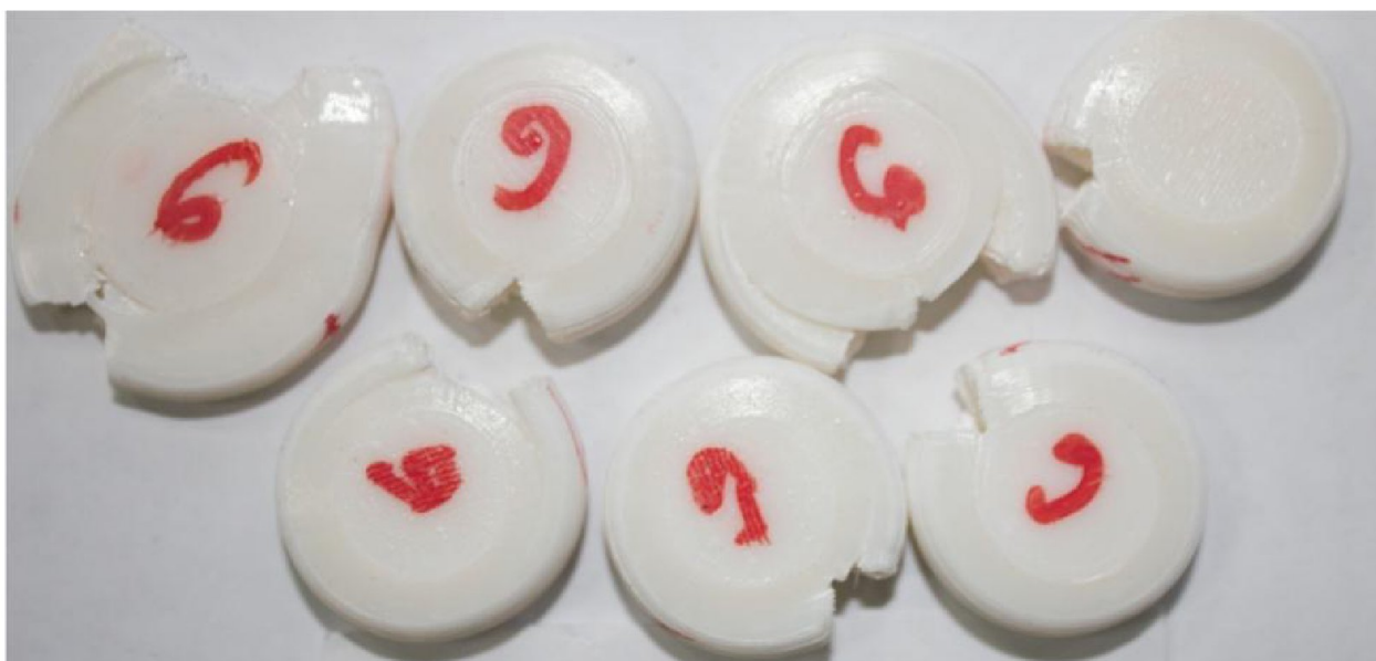
Фотографии элементарных образцов REC ETERNAL после испытаний
